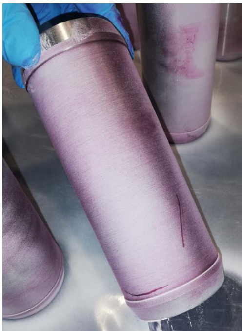
Obr. 1: Zkušební kus po nevyhovující kapilární kontrole
