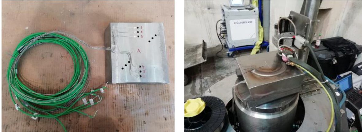
Obr. 4: Experimentální blok s osazením termočlánky vyvrtanými otvory vedoucími k teplem ovlivněné oblasti svarové housenky a pohled na navařovací pracoviště s měřením teplotních polí při navařování
