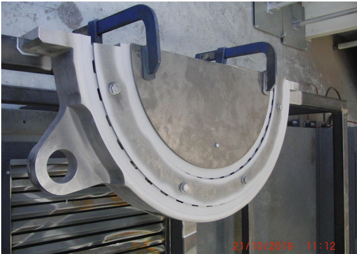
Obr. 1: Krytování regulační clony – plochy nepodléhající nástřiku: výpalek z plechu – půlkruh pro krytování vnitřního průměru clony [3]
