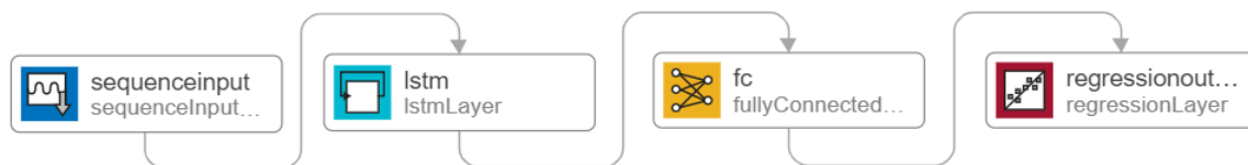
Obr. 4: Struktura LSTM sítě
