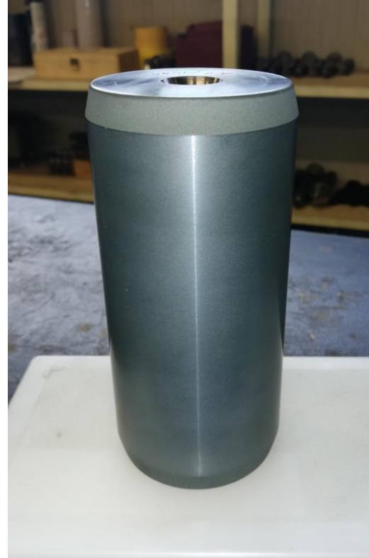
Obr. 4: Zkušební kus obrobeným žárovým nástřikem
