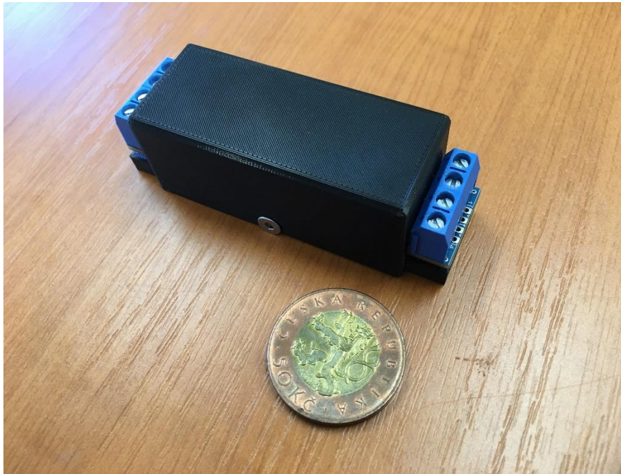
Obr. 4: Miniaturní modul pro kontinuální měření hloubky trhlin
