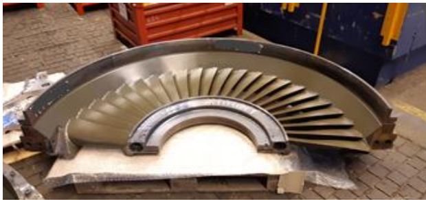
Obr. 6: Rozváděcí lopatky opatřeny hydrofobním povlakem – Doosan Škoda Power
