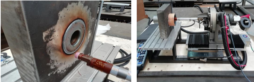
Obr. 6: Pohled na svařovací automat při osvojování technologie navařování
