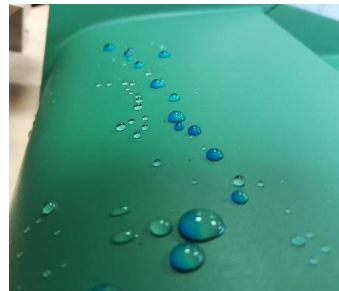
Obr. 6: Rozváděcí lopatky opatřeny hydrofobním povlakem – Doosan Škoda Power
