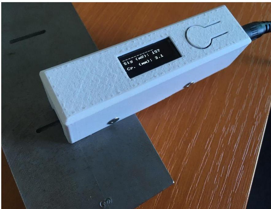
Obr. 3: Hotový prototyp zařízení při kalibraci na modelové trhlíně
