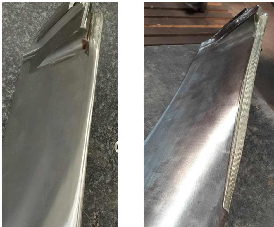
Obr. 8: Polotovary z výroby s finálním broušeným návarem, projektová fotografie
