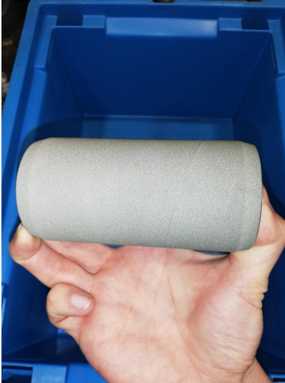
Obr. 3: Zkušební kus s provedeným žárovým nástřikem
