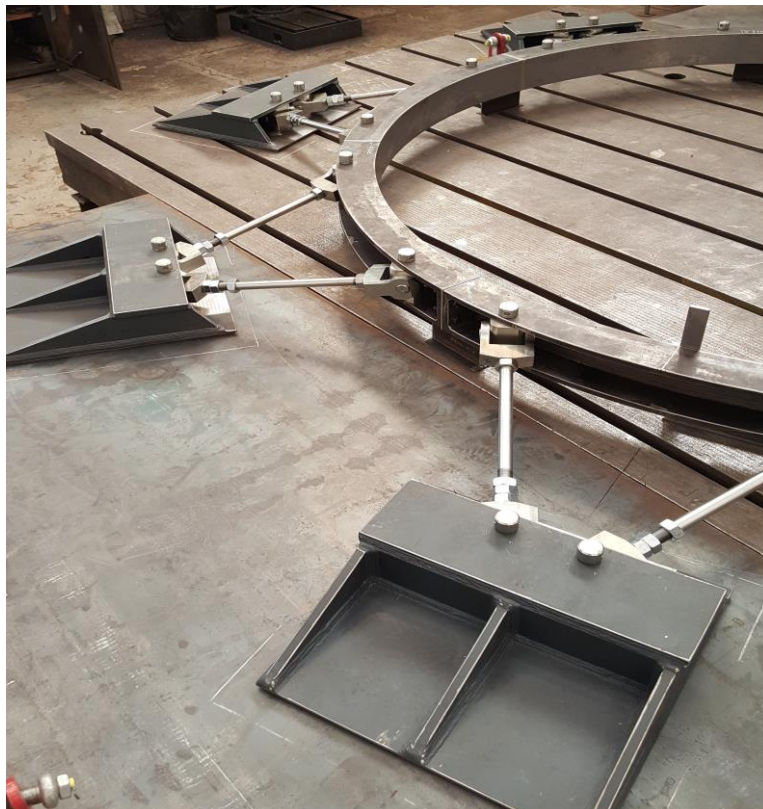
Obr. 2: Kontrolní montáž z odolnění kompenzátoru objemu
