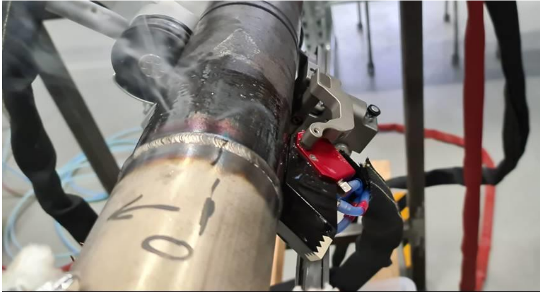
Obr. 2: Zařízení pro vysokoteplotní PAUT s vysokoteplotním manipulátorem
