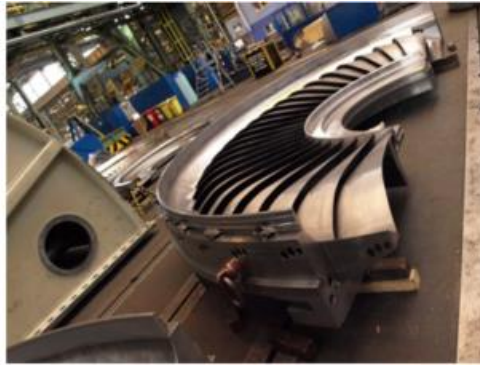
Obr. 5: Příklad rozváděcích lopatek opatřených drážkami pro odsávání vodních filmů [2]
