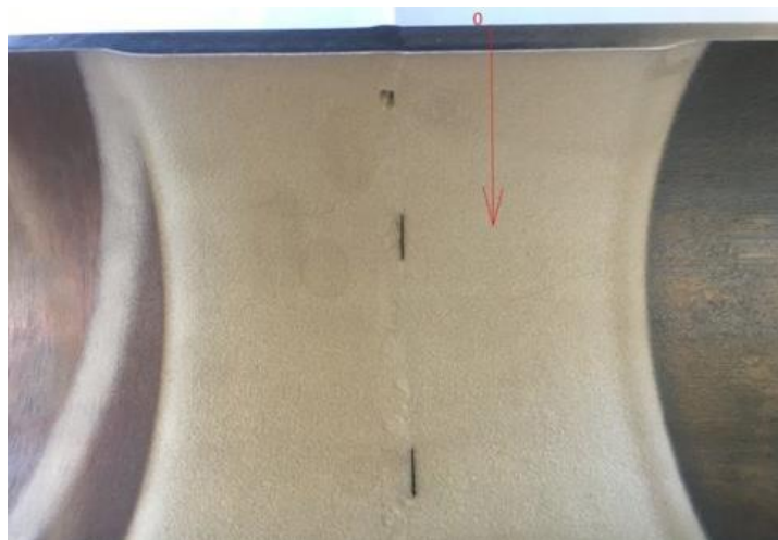
Obr. 5: Zkušební těleso s heterogenním svarovým spojem s vnitřním nástřikem Cold Spray a s EDM vruby o délce 10 mm a hloubce 1 resp. 2 mm v materiálu nástřiku
