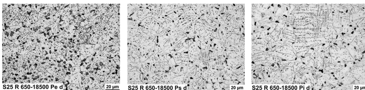
Obr. 1: Strukturní stav SUPER 304H po teplotní expozici po dobu 650 °C / 18500 hodin
