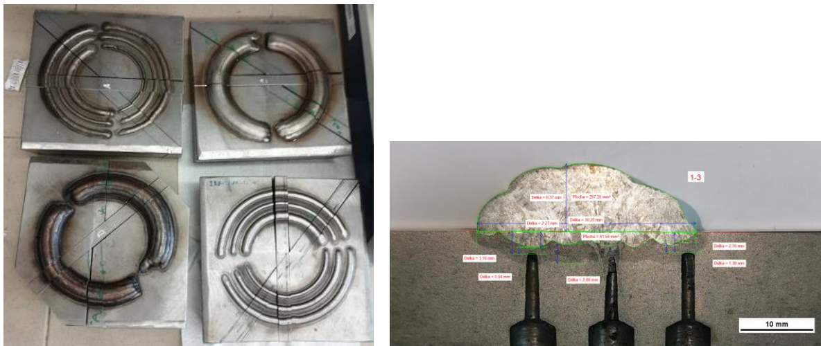
Obr. 5: Pohled na navařené bloky a řez umístěním termočlánků
