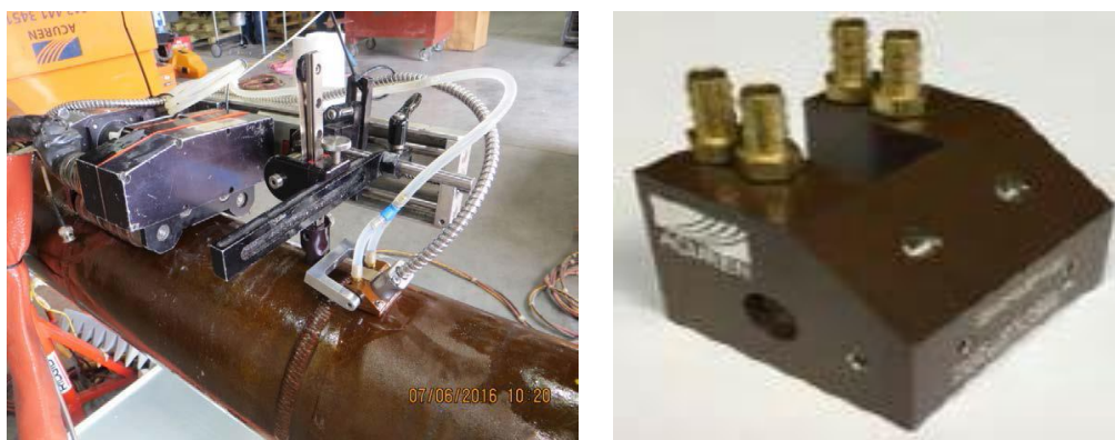
Obr. 3: Příklad chlazeného klínu a zobrazení experimentální sestavy na měření PAUT při vysokých teplotách
