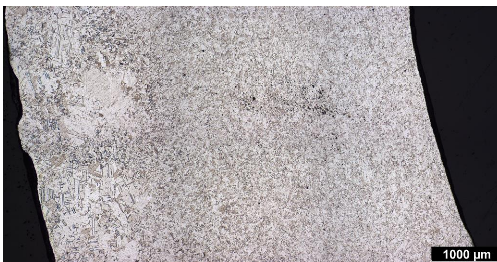
Obr. 5: Makrosnímek příčného řezu stěnou trubky
