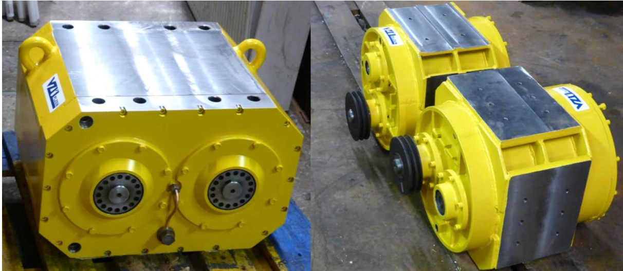
Obr. 1: Dynamické budiče s usměrněnou silou (90 kN vlevo, 40 kN vpravo nahoře a 60 kN vpravo dole), které slouží pro provádění dynamických zkoušek základů parních turbín
