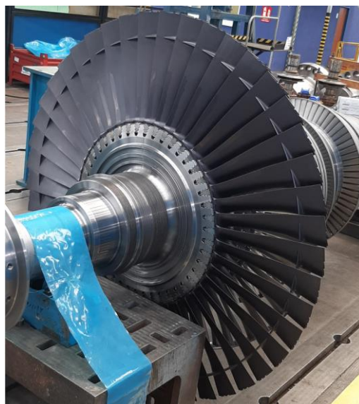
Obr. 5: Ukázka oběžných lopatek s PVD ochranou pro spalovnu odpadu – DSPW
