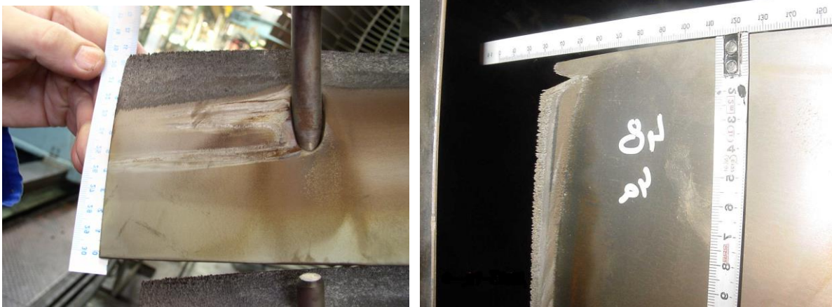
Obr. 2: Příklad erodovaných oběžných lopatek vlivem extrémního zatížení na konci životnosti – servis Doosan Škoda Power s.r.o. (DSPW)
