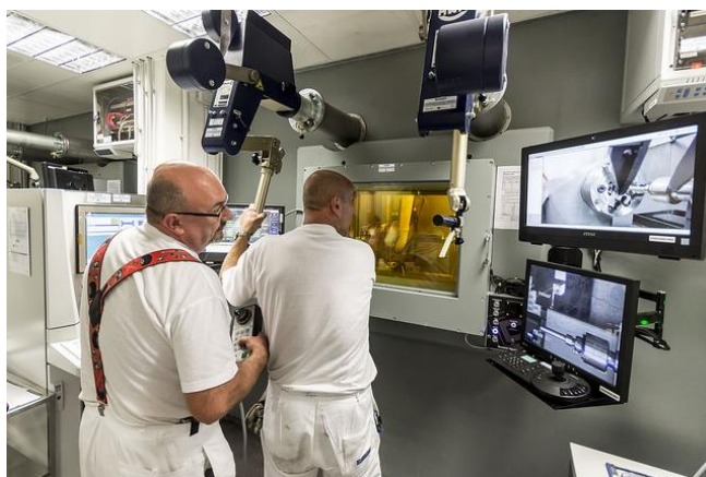
Obr. 6: Dálková manipulace se vzorky uvnitř horké komory
