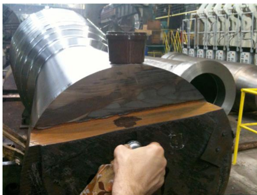
Obr. 12: Zkoušení výkovku axiálně
