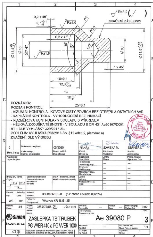
Obr. 2: Záslepka pro zaslepování teplosměnných trubek parogenerátorů VVER 440 / VVER 1000
