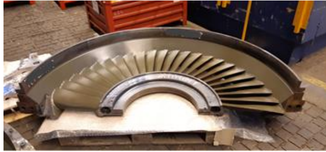
Obr. 4: Rozváděcí lopatky opatřeny hydrofobním povlakem – DSPW
