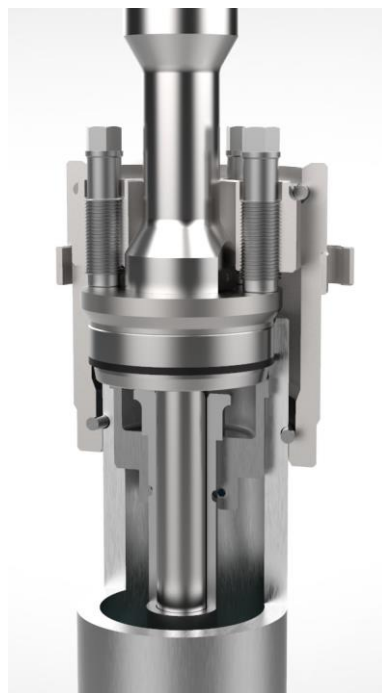
Obr. 3: Porovnání konstrukce přírubových spojů čidla polohy
