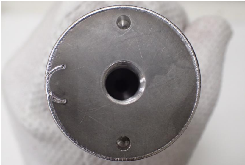
Obr. 5: Ukázka svaru uzavírající schránku
