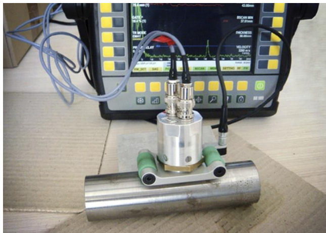
Obr. 19: EMAT sonda pro měření tloušťek trubek a materiálu umožňuje skenování bez použití vazebních prostředků
