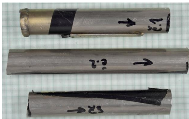
Obr. 4: Vyrezané vzorky s netesnosťami na analýzu po „hrubom“ rezaní
