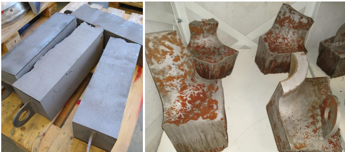
Obr. 4: Veľkorozmerné vzorky z plášťa a nátrubku kompenzátora objemu
