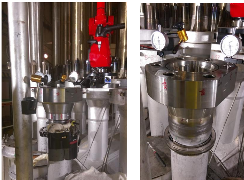
Obr. 4: Zvaracie zariadenie so špeciálnou zvaracou hlavou
