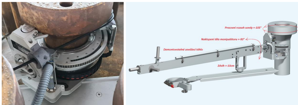
Obr. 1: Manipulátor na kontrolu nátrubků HRK
