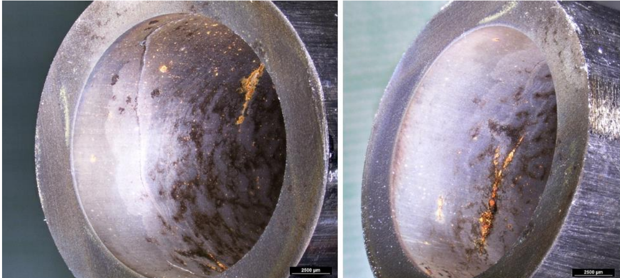
Obr. 8: Výskyt trhlin v referenčné „lokality 4“
