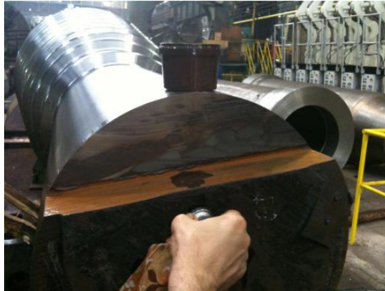
Obr. 13: Měření výkovku s rozsahem 4500 mm
