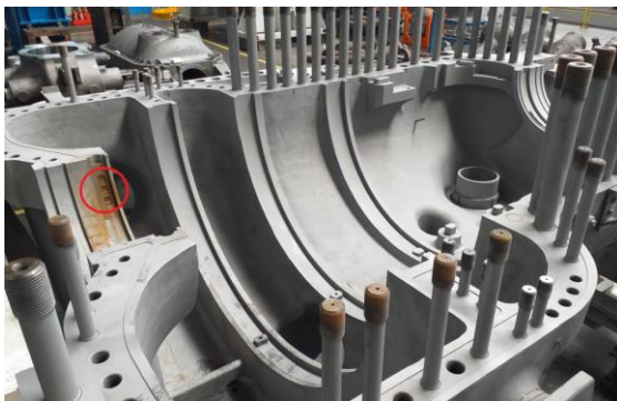
Obr. 2: Místo odběru a průběh odběru pomocí odběrového zařízení EDSE
