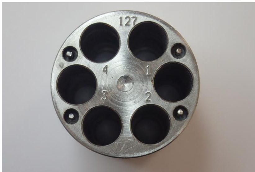
Obr. 4: Blok na zkušební tělesa pro tahové zkoušky s TIT
