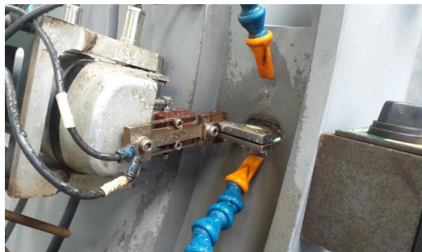
Obr. 2: Místo odběru a průběh odběru pomocí odběrového zařízení EDSE
