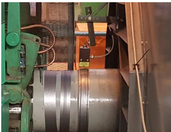
Obr. 6: Instalace měřicího systému KMT na rotor diesel generátoru (a) a frekvenční spektra smykového napětí v pořadí 0, 25, 50, 75, 100, 110 % výkonu (b)
