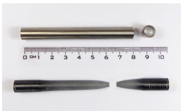
Obr. 1: Neexponovaný trubkový creepový vzorek před creepovou zkouškou a přetržený creepový vzorek po creepu při teplotě 400 °C a 125 MPa (doba do lomu 647 hodin)
