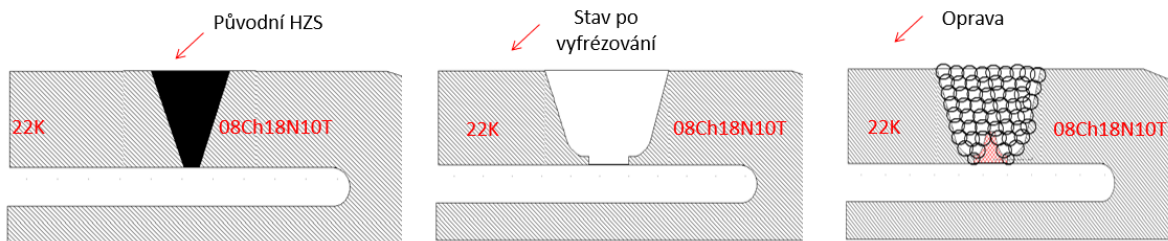
Obr. 6: Postup opravy
