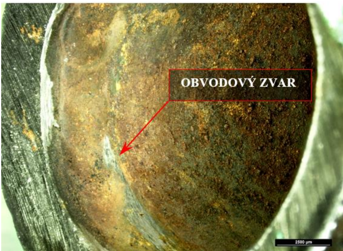
Obr. 3: Detail na vnútorný povrch obvodového zvaru a základného materiálu napadnutý plošnou koróziou (lokality 1)
