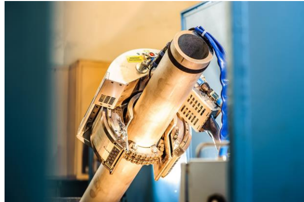
Obr. 5: Přenosná frézovací hlava ATF-150
