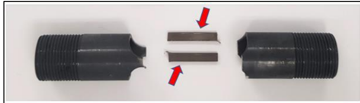
Obr. 5: Predopnutá PG rúrka po dekontaminácii
