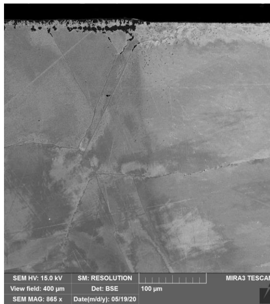
Obr. 3: Lokalizovaná oxidace po hranicích zrn
