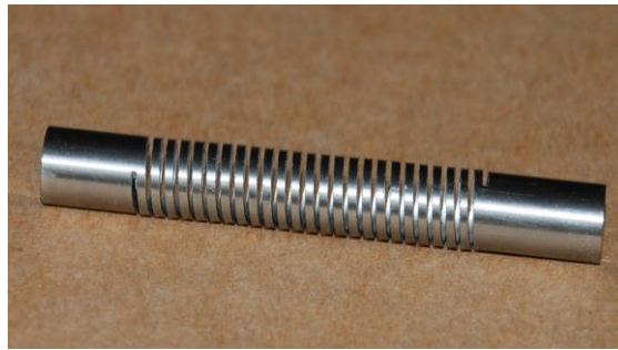
Obr. 4. Creepový vzorek helikoidního tvaru pro zkoušky povlakových trubek
