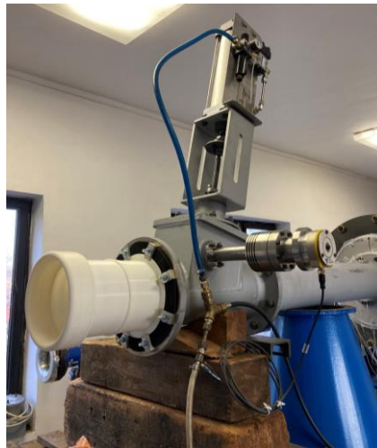
Obr. 5: Prototyp zpětné klapky byl prověřen ve Výzkumném a zkušební leteckém ústavu
