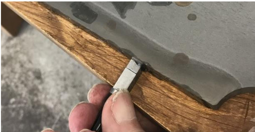
Obr. 6: Vzorek s hloubkovým zakalením – zakalení má tmavou barvu
