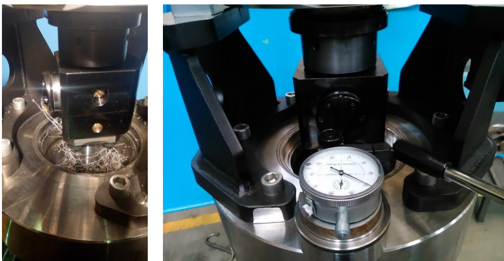
Obr. 5: Opracovanie privarenej prírubovej časti nátrubku zariadením PBS
