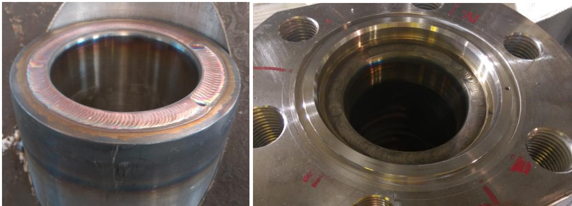
Obr. 7: Vkladanie a zvaranie tepelného tienenia
